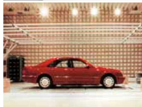
Potężne komory – laboratorium, w których bada się fale elektromagnetyczne emitowane np. przez samolot, pociąg czy samochód. Frankonia jest jedynym producentem takich komór w Polsce i jednym z niewielu na świecie. W komorach produkowanych przez Frankonię badano np. szybki pociąg TGV czy boeinga
